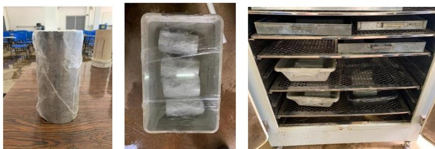
Figura 4 – Metodologia da cura térmica dos corpos de prova.
